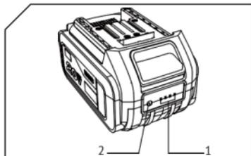
Когда инструмент включен, индикатор заряда показывает оставшийся заряд батареи. Нажмите кнопку проверки на блоке аккумуляторов для проверки заряда. Индикаторы включатся на несколько секунд. Примечание: в зависимости от условий эксплуатации и температуры окружающего воздуха индикация может незначительно отличаться от фактического значения.
