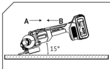
ВСЕГДА крепко держите инструмент одной рукой за корпус, а другой за боковую рукоятку. Включите инструмент и поднесите круг или диск к обрабатываемой детали. В общем край диска необходимо держать под углом примерно в  $15^\circ$  к поверхности обрабатываемой детали.
