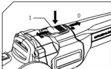
Функция предотвращения случайного перезапуска не позволяет запустить инструмент снова, даже если в него вставлен аккумулятор, а переключатель находится в положении ВКЛ. Для повторного запуска инструмента переведите переключатель в положение ВЫКЛ, а затем снова в положение ВКЛ.
