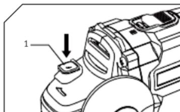
Нажмите на фиксатор вала для предотвращения вращения шпинделя при установке или снятии дополнительных принадлежностей. Перед установкой аккумуляторного блока проверяйте фиксатор вала.
