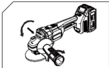
Прочно закрепите рукоятку как указано на рисунке. Всегда проверяйте надежность установки боковой рукоятки перед началом работы.
